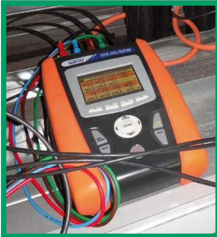
moderne Mess- technik: hier ein Netzanalysegerät
